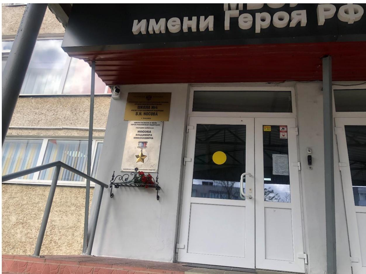
Центральный вход в здание школы оборудован желтыми кругами на стеклянных дверях, вход выделен желтой полосой. На входе в здание установлена табличка шрифтом Брайля.
